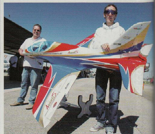
**11 KILOS DE PESO EN VACÍO.** ACABADO EN ROJO Y EN AZUL QUE LE CONFERÍA UNA LÍNEA MUY AGRADABLE DE VER EN EL AIRE. PARA LOGRAR ESA LIGEREZA Y RESISTENCIA SE HA REALIZADO **LA CONSTRUCCIÓN DEL FUSELAJE EN COMPOSITE Y LAS ALAS Y ESTABILIZADORES EN Balsa** RECUBIERTA CON ORACOVER.
